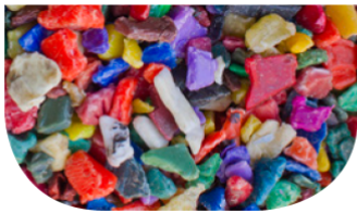
PEAD inyección cajas
