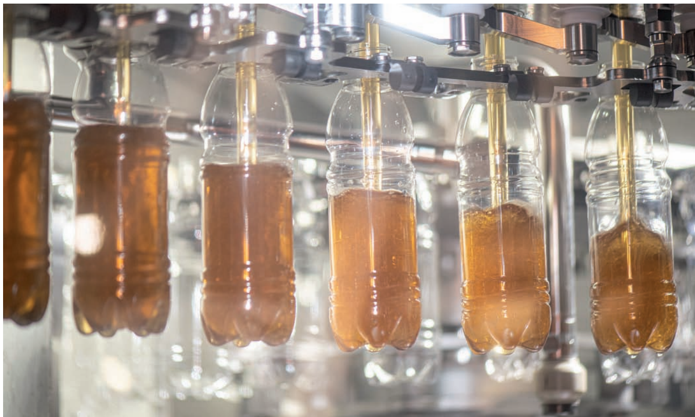
El Contipure AseptBloc DN de Spitz esteriliza con peróxido de hidrógeno gaseoso y procesa hasta 24.000 envases por hora.
