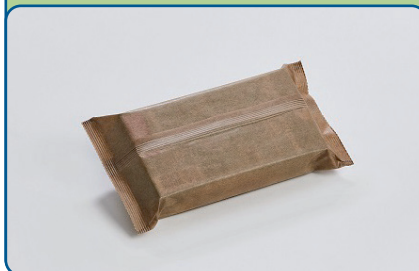
El embalaje de flowpack con una costura longitudinal por encima / por debajo sólo es posible en la actualidad con papel revestido, es decir, con un revestimiento sellable mínimo (por ejemplo, PE o adhesivo frío)
