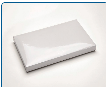
Envase retráctil clásico: caja de bombones con un film que se ajusta extremadamente bien (superposición inferior e ionización)
