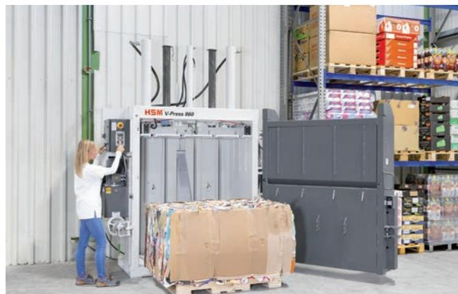
Las prensas de empaquetar HSM reducen el volumen de materiales reciclables hasta en un 95% y, con las balas sin mezclar, producen una materia prima secundaria, que se reintegra fácilmente al circuito de reciclaje. Existe un efecto secundario positivo: las balas tienen un valor de mercado considerable cuando superan cierto peso. La alta compresión de las empaquetadoras HSM ahorra espacio de almacenamiento y reduce la carga de transporte. Otra ventaja es que se requiere menos material de fleje.
