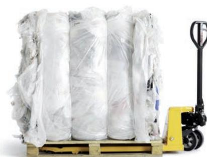
muestra el estado real de la máquina. Las balas comercializables, con las dimensiones máximas de 1200x780x1500 mm, alcanzan un peso dependiente del material de hasta 550 kilogramos y se mantienen unidas por un fleje de alambre cuádruple. El fleje de alambre es especialmente adecuado para materiales expansivos como láminas, etc. La HSM V-Press 860 plus B
