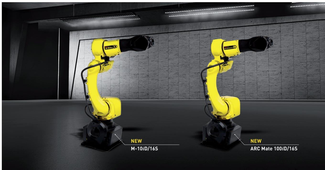
**E**l M-10iD/16S ofrece alta velocidad y una excelente precisión. Diseñado específicamente para lugares de trabajo estrechos, este modelo versátil puede utilizarse también en aplicaciones que requieren montaje invertido. Además, el robot ofrece una capacidad de carga de hasta 16 kg, lo que supone una mejora importante en comparación con los modelos anteriores.
