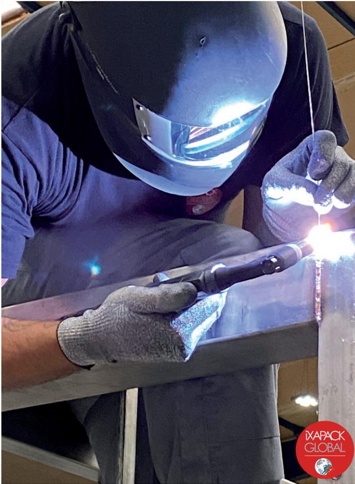
es fabricado, mecanizado, plegado, soldado dentro de iXAPACK GLOBAL, para una producción a medida adaptada a la demanda. Entonces, cada máquina es pre-ensamblada y ensamblada (siempre en los talleres de la empresa) para dar paso a las fases de prueba, en colaboración con los clientes. Unos pocos ajustes finales, y el equipo está listo para ser entregado.
