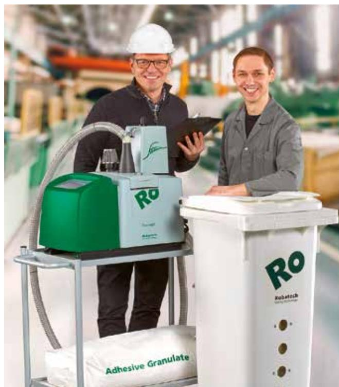
alcanzan temperaturas de hasta 200°C. Al abrir el tanque para llenarlo, la persona puede sufrir, entre otras lesiones, quemaduras por salpicaduras de adhesivo o por el contacto con adhesivo ya fundido. Con un sistema de llenado automático es posible evitar estos riesgos.
