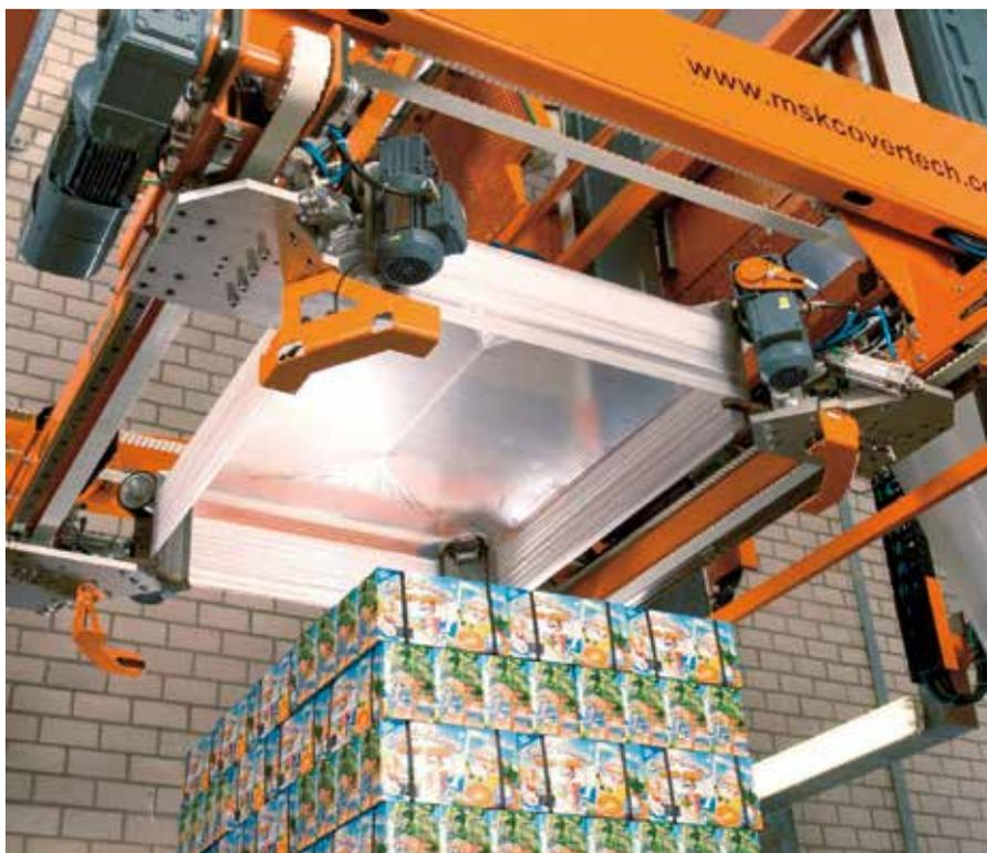
**L**a última generación de enfundadoras completamente automáticas MSK Tensiontech con film estirable y MSK Multitech, MSK Paratech con film retráctil; permiten el embalaje de varios tipos de cargas paletizadas. El film está respectivamente estirado o retráctil dependiendo de cada formato de palet con el fin de obtener una protección óptima y una estabilidad de la carga que también cumple con las nuevas directivas europeas respecto al aseguramiento de las cargas.
