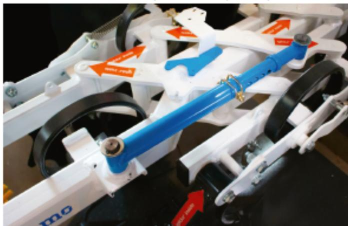
*En cuanto al ajuste lateral, los diseñadores confían en 18 cojinetes de fricción exentos de lubricación, fabricados con el material polivalente iglidur G para cada elemento de escardado (Fuente: igus GmbH)*
