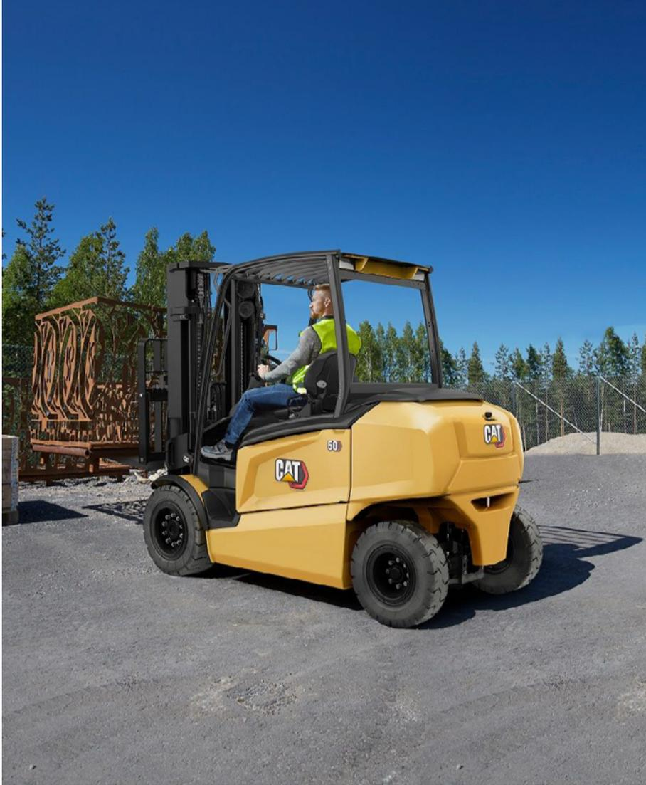
comportamiento del conductor y garantiza la fluidez de todos los movimientos, arranques y paradas. El control de curvas inteligente **maximiza la seguridad** en las curvas ajustando suavemente la velocidad de la carretilla y reduciendo al mínimo las fuerzas laterales. La función PowerBurst aporta aceleración adicional o par de ascenso cuando es necesario, mientras que el bloqueo eléctrico del diferencial es especialmente útil en superficies resbaladizas.
