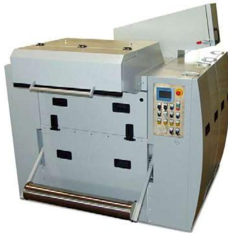
En el stand de Getecha en la feria K, en el pabellón 9, se puede ver el molino RS 30090-E, de alto rendimiento para el molido de esqueletos en el termoformado.
