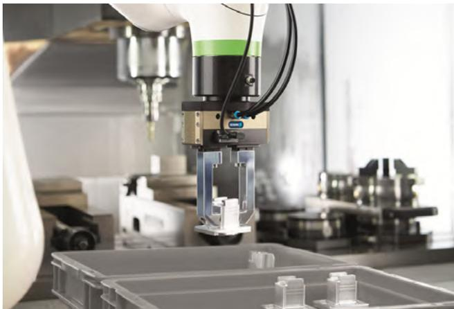
La nueva PGL-plus-P es la primera pinza neumática que ofrece un mantenimiento seguro de la fuerza de agarre certificado y un sistema de sensores IOL ya integrado.
