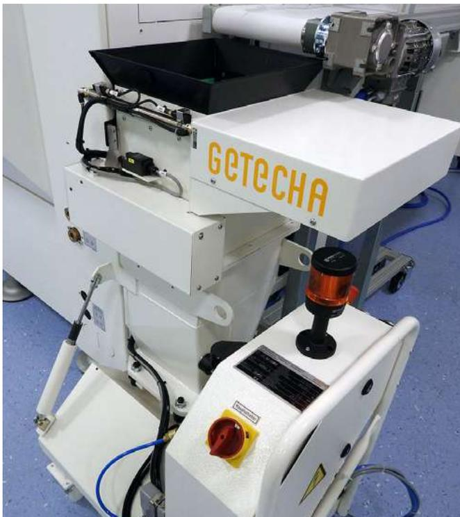
Una solución universal de primera calidad para el molido de bebederos y piezas defectuosas de inyección es el granulador junto a la prensa GRS 180, que Getecha presentará en la K de este año.
