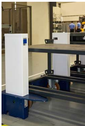
Estación de transferencia: los carros para los palets se pueden depositar aquí. Dependiendo del pedido, los AGV recogen los palets o cargan nuevos palets en los carros aparcados en la estación de transferencia.
