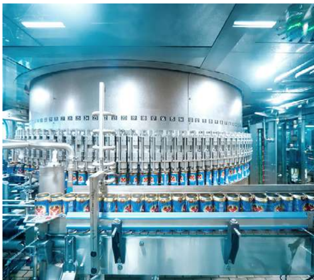
Las secciones de llenado y cierre del sistema de bloque conjunto SmartCan by KHS/Ferrum se caracterizan por su concepto de higiene optimizado. Copyright: Roth und Schmid Fotografie
