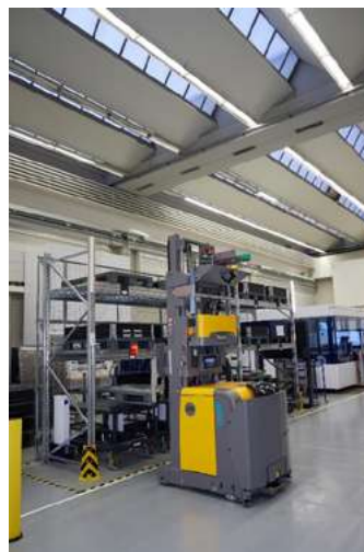
Un AGV en pleno funcionamiento: el vehículo de guiado automático carga una estación de transferencia con material.
